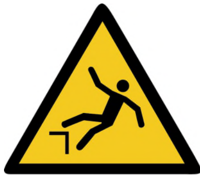
W008: Warnung vor Absturzgefahr
